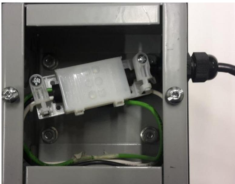
Fig. 44 *Collegamenti elettrici finiti nel proiettore 74-00013-01*
